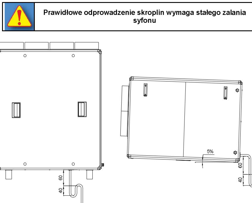
Rys. Nr 5 Syfon na skropliny i pochylenie wersji podwieszanej.
